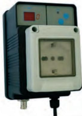
La sonde Rx analyse en continu la valeur Redox de l'eau de la piscine et la compare avec la valeur souhaitée, entraînant la mise en marche ou l'arrêt de l'électrolyseur.
