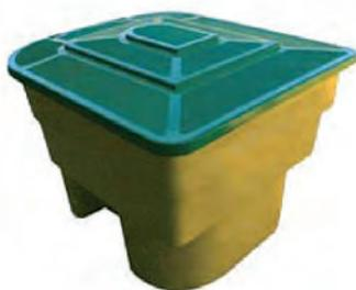
Local technique à enterrer pour équipement de filtration, il est fabriqué en polyester laminé avec fibre de verre et possède un couvercle renforcé de couleur verte. Ce local de très grande dimension : 1.75 x 1.55 x 1.15 m. Il peut accueillir des filtres SIDE jusqu'à 900 mm. Vous pouvez ajouter pas mal d'option mise à part la pompe et le filtre comme un coffret électrique, électrolyseur et régul PH ou encore un surpresseur.
